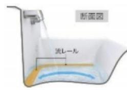
ボールの底面を凹型にすることで、一旦水流をボール全体に流します。
