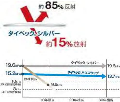
10年相当=44mJ/m<sup>2</sup>の紫外線照射+90℃ 7週間の加熱試験
