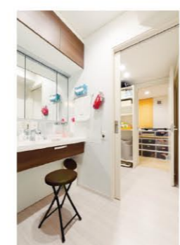
壁面はホーローパネルでドライヤーやティッシュ、タオル掛けをマグネットで貼付け収納。
