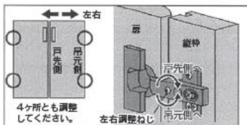
左右調整ねじを回し調整します。
