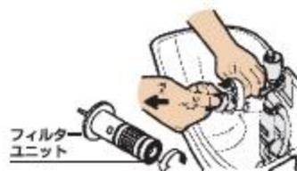
③フィルターユニットを左に約 10 度回して、引き抜きます。
