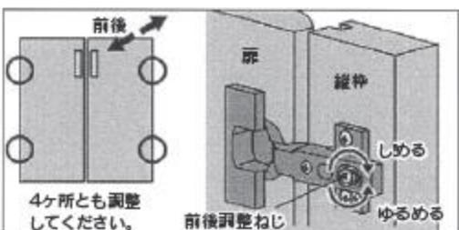
前後調整ねじをゆるめ調整します。調整後確実に調整ねじをしめてください。
