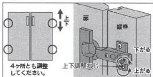
上下調整ねじを回し調整します。
