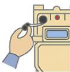
2 復帰ボタンのキャップを手で左に回し、キャップを外して下さい。
