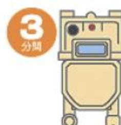
4 約3分間待ちます。この間にマイコンメーターがガス漏れがないかを確認。赤ランプの点灯が消えるとガスが使えます。
