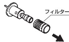
④フィルターを左に数回回して引き抜きます。
