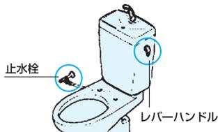
①マイナスドライバーで止水栓を右（時計まわり）に回して閉め、水を止めます。タンク内の水を流します。
