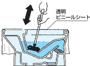
②ラバーカップでつまりを取ります。便器の排水口にラバーカップを密着させ、静かに押し付け、勢い良く引きます。排水が引き込まれるまで繰り返します。
